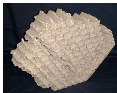
Поврежденная коррозией гексагональная плита HT-99 (99% Al 2 O 3 )
